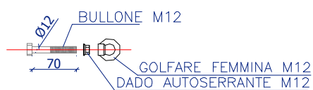
Particolare creazione Punto Ancoraggio GA1 ( Cod. AT514 )
